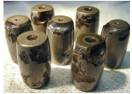
Rouleaux d'un roulement à rotule sur rouleaux de contrefaçon.
