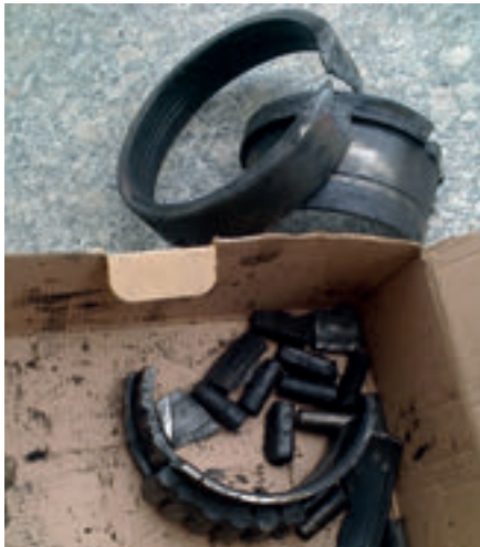
Roulement contrefait après plusieurs jours d'utilisation.
